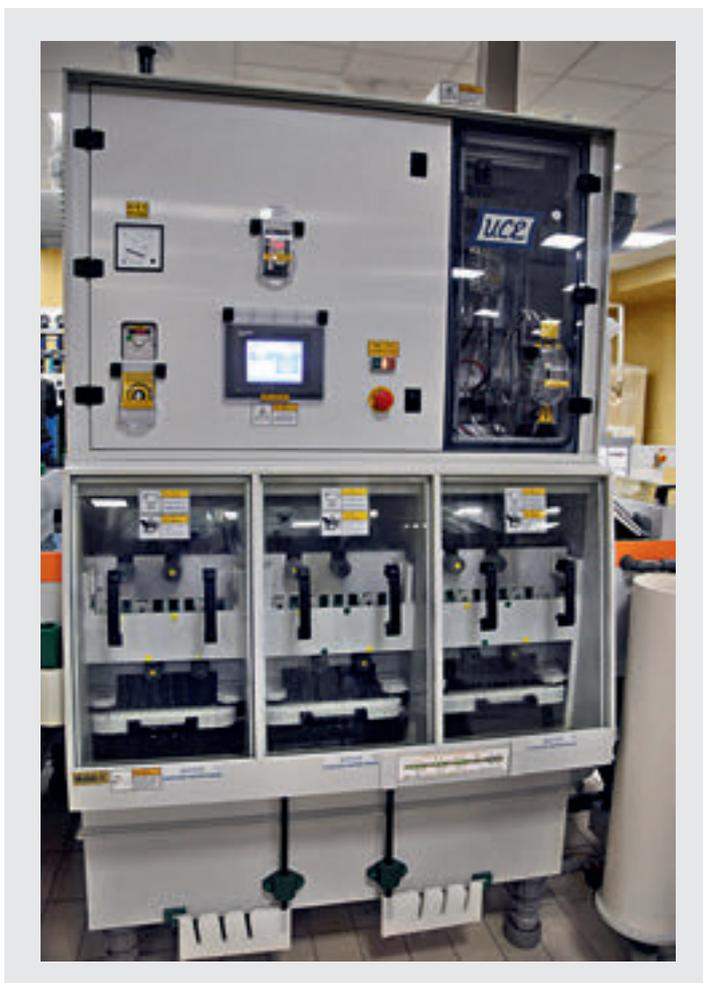
Верхнее расположение блока управления на одной из машин производства компании Universal
