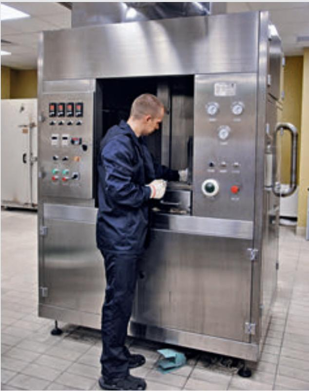
Установка горячего лужения (снизу) и линия подготовки к нему
