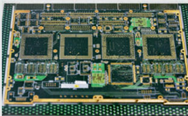
Плата из армированного полиимида с заданным волновым сопротивлением в двух вариантах – с разным финишным покрытием: слева – горячее лужение Sn-Pb, справа – иммерсионное золото
