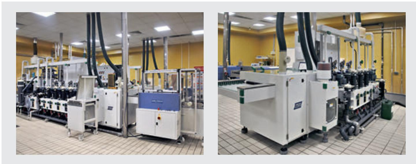
Конвейерные линии производства компании Universal: слева – линия снятия металлорезиста; справа – линия проявления паяльной маски
